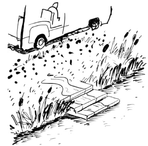
Bloemrijke grasbermen, natuurvriendelijke oevers en betonnen cascade-elementen voor piekafvoer
